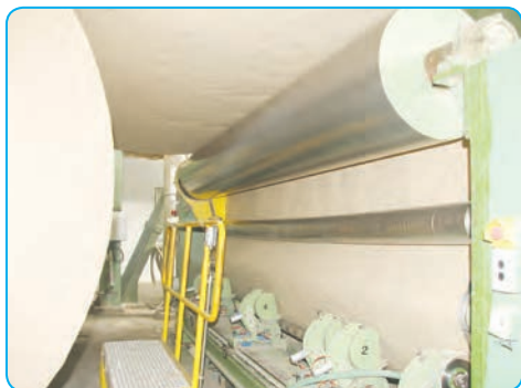
غلتک آهنی برای صاف کردن خمیر کاغذ
